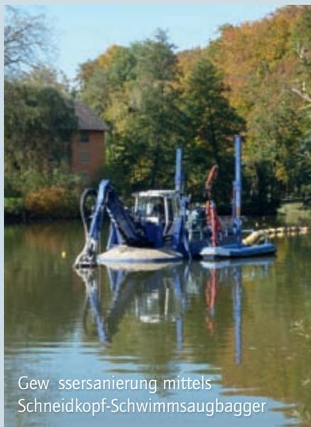
Gewässersanierung mittels Schneidkopf-Schwimmsaugbagger
