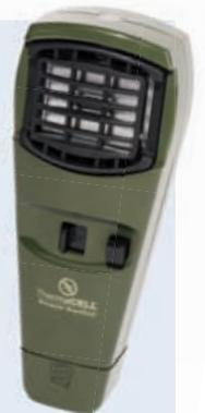
Damit wird der Heizvorgang gestartet, das Heizelement erwärmt das Plättchen und das Abwehrmittel beginnt zu verdampfen. Das Mittel verteilt sich – praktisch geruchlos – in der Umgebung und beginnt nach 2-3 Minuten eine ca. 4,5 x 4,5m „mückenfreie Zone“ aufzubauen. Diese ist nach ca. 10 Minuten voll etabliert.
