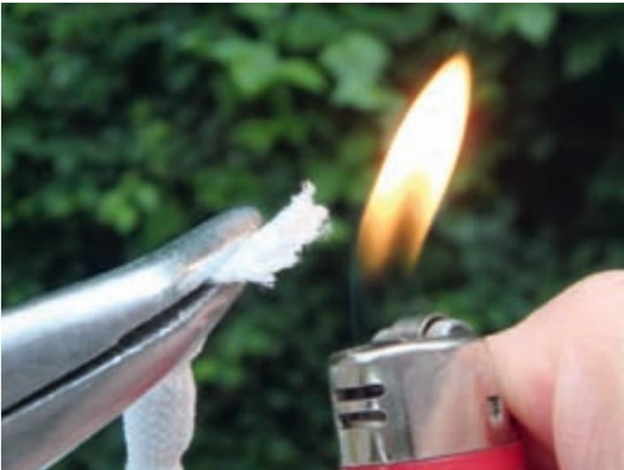
**03** Die losen Enden der Ummantelung mit einer Zange zusammendrücken und mittels Feuerzeug verschmelzen
