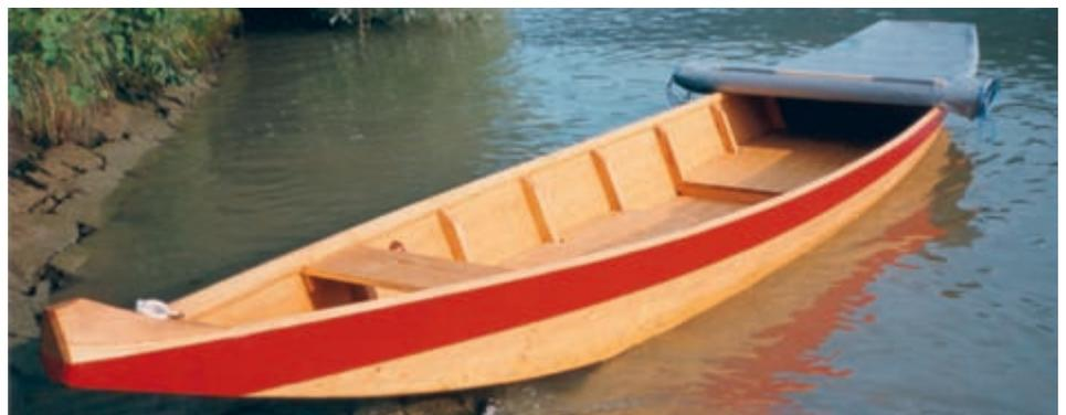
ben Zillen nämlich einen flachen Boden und können so problemlos über Sandbänke ans Ufer gezogen werden. Zudem muss man sich bei 15 Zentimetern Tiefgang keine Gedanken über Unterwasserhindernisse machen. Der flache Boden bürgt für wenig Fahrwiderstand und eine stabile Lage im Wasser. Stehen im Boot ist kein Problem.
