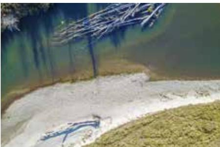
Ausschnitt aus dem strukturierten Kremser Kamp-Umleitungsgerinne. Hier befinden sich Schlüssellebensräume auf engstem Raum (rasch überströmte Kiesfurt, Kolk mit Totholz und Versteckmöglichkeiten, Kiesbank mit flachem Verlauf bis in den Hochwasserbereich).
